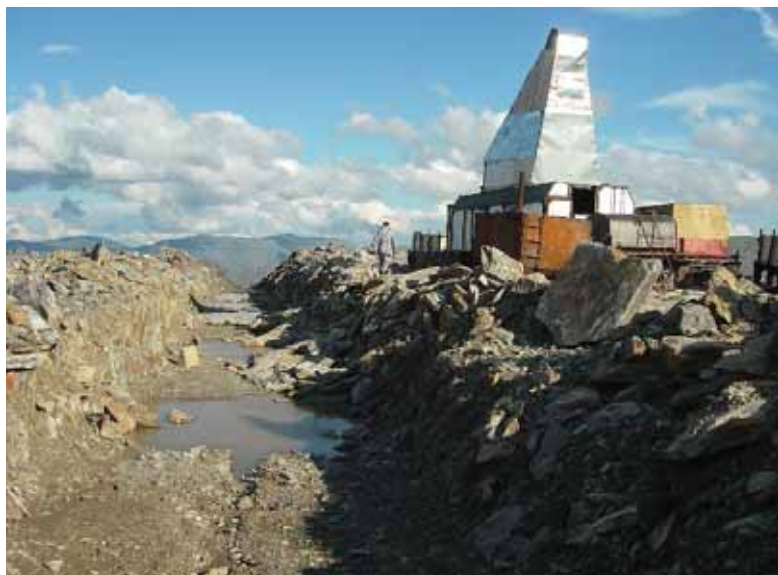
Буровая установка. Рядом – геологоразведочная канава, образовавшаяся в результате взрывных работ Фото из архива сайта www.greenpeace.org
