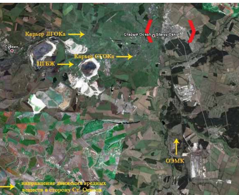
Схема расположения предприятий и направления движения вредных выбросов относительно Старого Оскола Фото из архива сайта www.kavicom.ru
